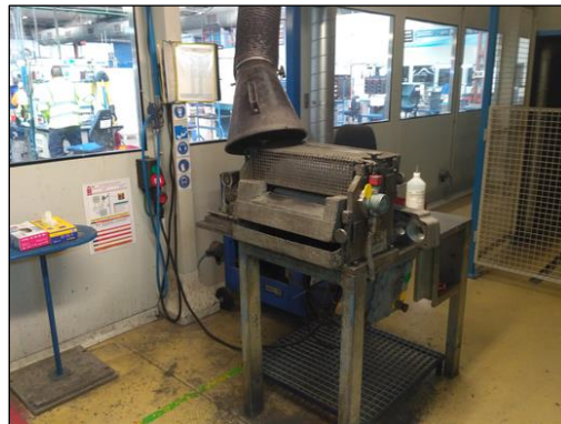
Detalle del proceso de recubrimiento por rodillos
