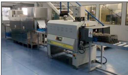
Detalle de la línea de limpieza superficial
