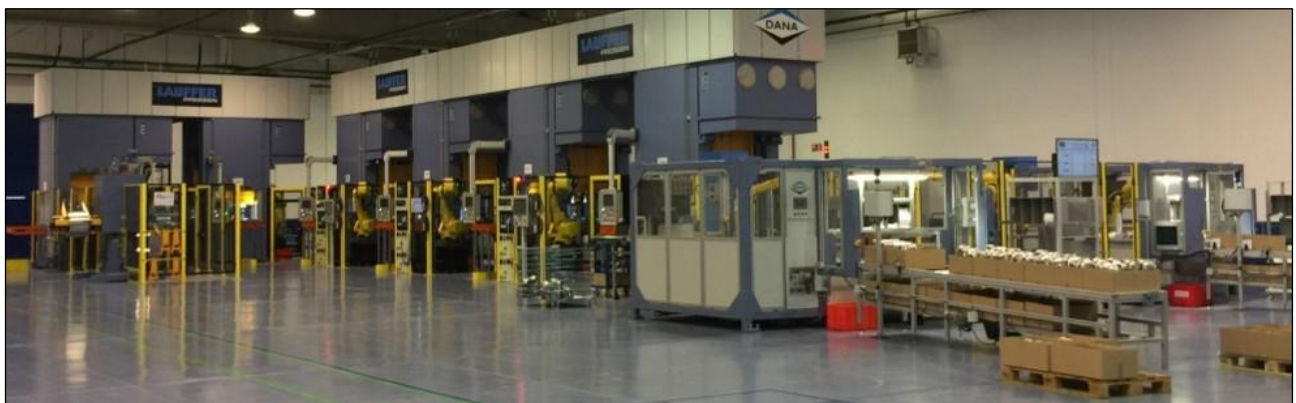
Línea automatizada de fabricación de pantallas térmicas (TAPS) de aislamiento directo (material BiTEC).
